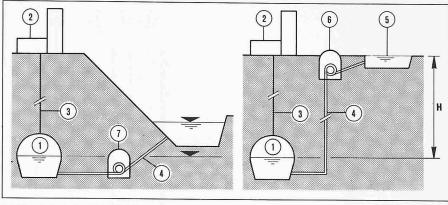
Prinzip des Gleichdruckspeichers mit gepumpter Wasservorlage. l Speicherkaverne, 2 Maschinenhaus, 3 Vertikalschacht, 4 Wasserschacht, 5 Ausgleichsbecken, 6 Druckerhö-
