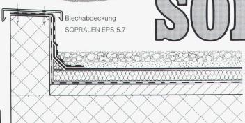
Schutzschicht SOPRALEN EJ 3.5 + EV 3.2 Wärmedämmschicht
