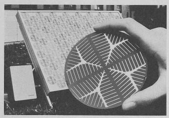
Das neue Solarmodul (SM 144) für 120 Watt arbeitet mit 144 monokristallinen Siliziumscheiben von je 100 mm Durchmesser und kann in vier Varianten für Nennspannungen von 8/16/32/64 Volt bezogen werden. Die entsprechenden (Kurzschluss)-Ströme betragen 16/8/4/2 Ampere. Bei 1 m Breite und 1,46 m Länge ist das Modul 27 kg schwer
