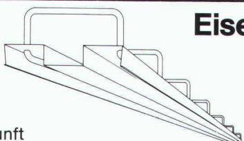
**Eisenbetonanschlüsse mit Verzahnung aus Streckmetall.**
