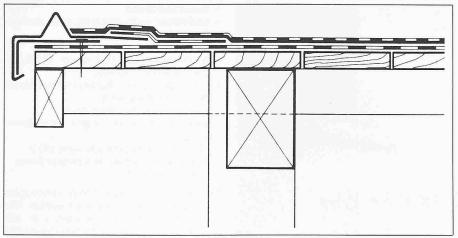
Bild 6. Witterungsbeständige Dachabdichtung ohne Kies und Sand (Querschnitt)
