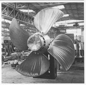
Schiffspropeller (verstellbar) mit sogenannten «Skew»-Schaufeln
