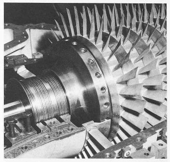
Rotor eines Axialkompressors
