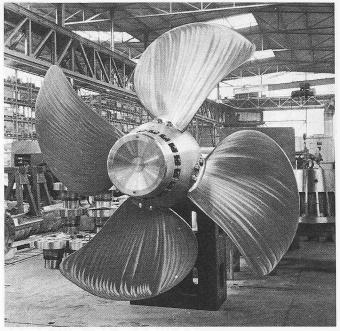
Schiffspropeller (verstellbar) mit sogenannten «Skew»-Schaufeln
