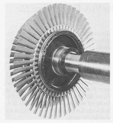
Rotor einer Heliumturbine (Drehzahl bis 300 000 U/min); links der Expanderrotor, rechts der Bremskompressor
