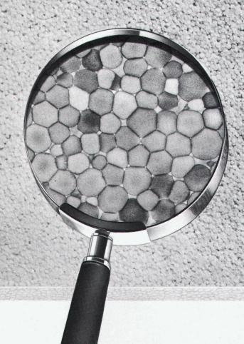
1 m<sup>3</sup> Polystyrol-Hartschaum besteht aus rund 3-6 Milliarden mikroskopisch kleinen luftgefüllten Zellen: Darauf beruhen die hervorragende Wärme-Dämmfähigkeit und die hohe Druckfestigkeit von Polystyrol-Hartschaum. Das leichte Eigengewicht und die vielen anderen vorzüglichen Eigenschaften machen Polystyrol-Hartschaum zum idealen Isoliermaterial.
