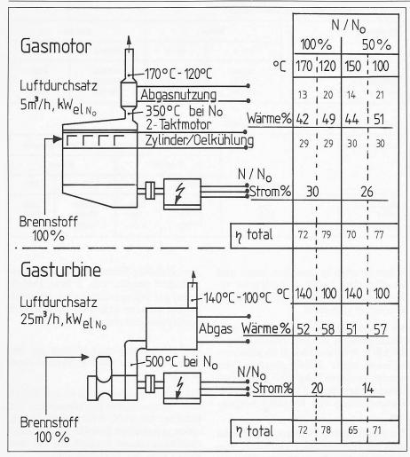
Bild 3. Energiebilanz zum Gasmotor und zur Gasturbine für Voll- und Halblast an der Welle, Temperaturniveaux der Abwärmemengen
