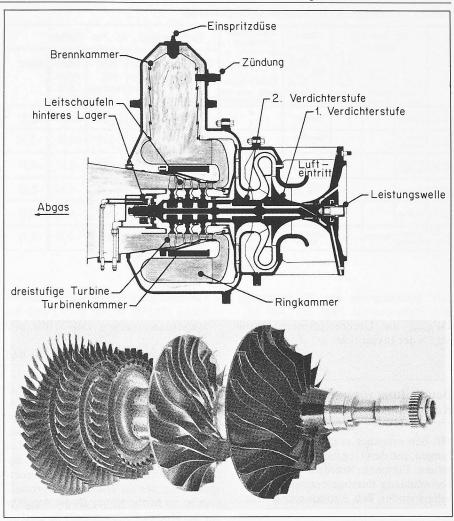
Bild 4. Schnitt durch Gasturbine, Ansicht der Verdichter-Turbinen-Einheit
