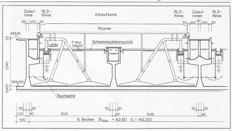
Bild 1. Querschnitt durch Nachklärbecken der Hauptstufe
