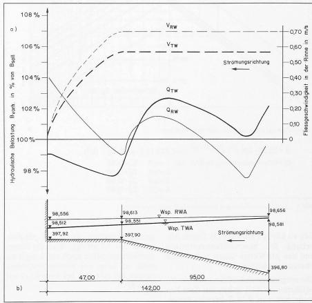
Bild 2. a) Hydraulische Belastung und Fliessgeschwindigkeit im Zulaufgerinne der Nachklärbecken b) Wasserspiegellagen im Zulaufgerinne der Nachklärbecken
