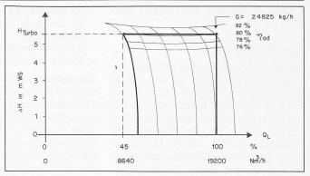
Q-H-Kennlinien (Turboverdichter Typ KA 22 S)
