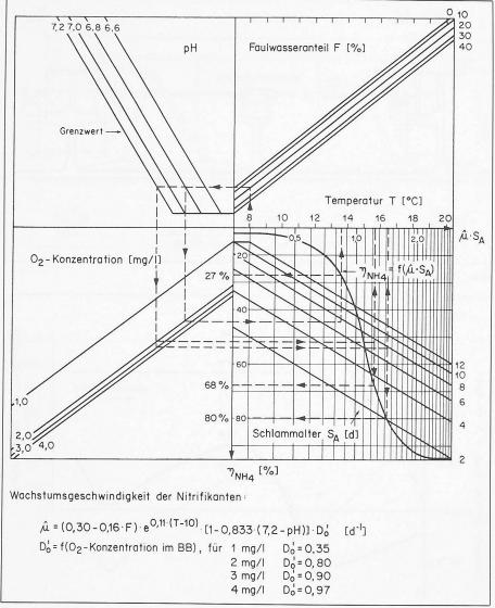
Bild 3. Nitrifikationsleistung in Funktion der Hauptkomponenten
