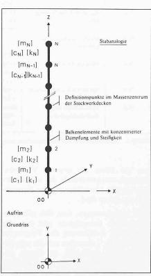
Bild 6. Problematik der geeigneten Wahl des physikalisch-mathematischen Modells: Mit der Stabanalogie können die wirklich grössten Kräfte in den exponierten Tragwerkteilen (z. B. Eckstützen, -wände) nicht bestimmt werden
