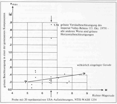
Bild 5. Problematik der geeigneten Wahl der seismischen Kenngrösse: Im weiteren Herdbereich ist keine Korrelation zwischen den grössten Beschleunigungen der Starkbeben und den zugehörigen Richter-Magnituden zu erwarten (Probe mit 20 repräsentativen USA-Aufzeichnungen, NTIS-WASH 1254)
