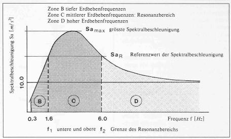
Bild 1. Normierte Bemessungs-Spektralform auf Mittelwert-Basis, repräsentativ für mittelsteife Böden und 2% Dämpfung
