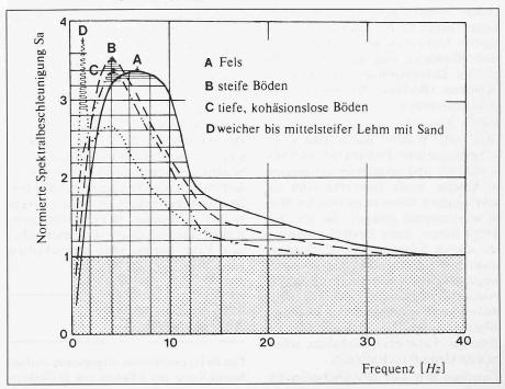
Erdbebenspektrum. Da Bauwerk und Baugrund eine ähnliche Steifigkeit besitzen, reagieren sie auf Starkbeben als steife Einheit. Die Widerstandsfähigkeit steifer Bauwerke auf steifen Böden unterliegt damit zwei natürlichen Grenzen:
