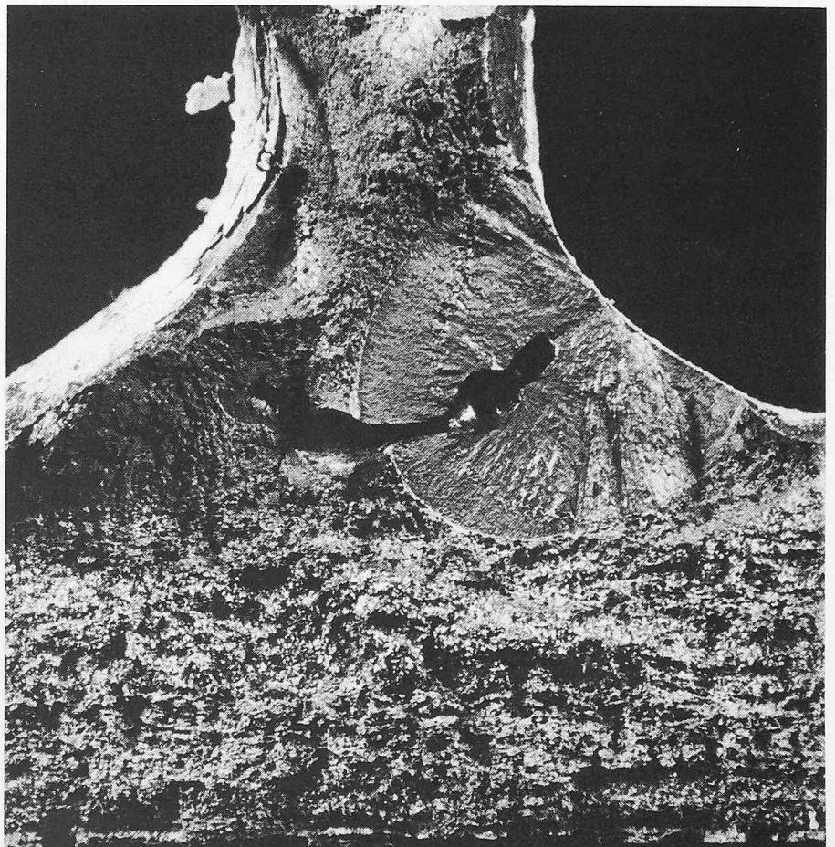
Bild 1. Verlauf eines Ermüdungsbruches
