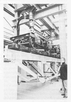
Bild 6. Eisenbahnbrücke im Ermüdungssimulator
