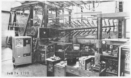
Bild 6. Änderungen in der Einsatzartz der DH-112 Venom der Schweizer Flugwaffe (oben) führten zur Wiederholung des umfangreichen Ermüdungsversuches (unten), da frühere Erkenntnisse ungültig wurden. Durch intensive Forschungs- und Überwachungsarbeiten gelang es dem Eidg. Flugzeugwerk Emmen, die vom Hersteller mit 500 Flugstunden angegebene Lebensdauer des Flugzeuges auf etwa 2000 Stunden zu erhöhen
