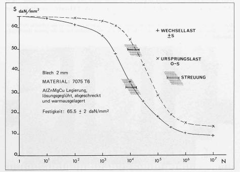
nur mit einem erheblichen Versuchsaufwand möglich. Darüber hinaus sind die Ergebnisse bei ein und demselben Werkstoff von vielen Faktoren abhängig (z.B. Amplitude, Verhältnis und Vorzeichen der Lasten, Grösse und Form der Prüflinge usw.). Schliesslich sind die Ergebnisse von zwangsläufig vereinfachten Laborversuchen nur beschränkt auf mehr oder weniger komplexe Strukturen oder Bauteile übertragbar.
