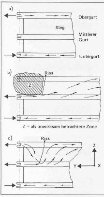
Bild 7. Fatale Folgen einer unvollständigen Fail-Safe-Analyse
