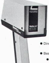
Neuartige, berührungslose Messuna von Kältebrücken. Isolationsdefekten, ungenügenden **Abdichtungen**
