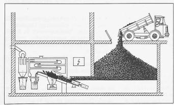
Bild 6. Beschickung mit Spiralförderer
