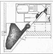
Bild 4. Topfire mit hochliegender Beschickung
