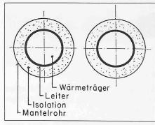
Bild 1. Konventionelle erdverlegte Fernheizleitung (Vor- und Rücklauf)
