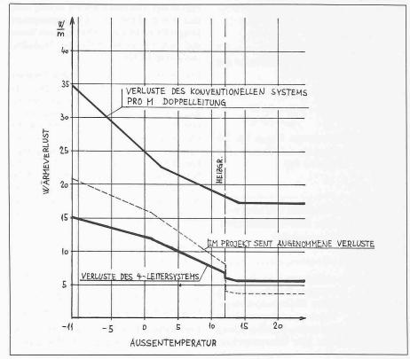
Bild 13. Wärmeverluste in Funktion der Aussentemperatur
