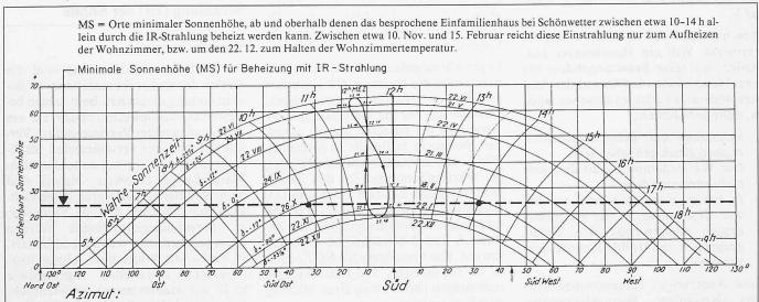
Tabelle 5c. Sonnenschein-Intensität und -Dauer, sowie mögliche Gebäude-Einheizung durch Sonnenstrahlen
