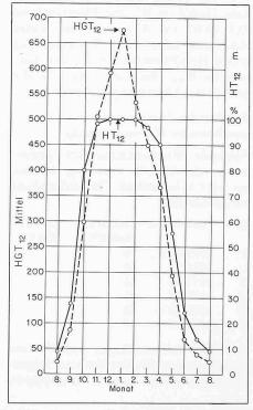
Bild 1. Verteilung der Heiztage (HT12) und der Heizgradtage (HGT<sub>12</sub>) auf die Heizperiode (Sept. bis Aug.). Eingetragen ist das Mittel aus den Heizperioden 1977/78, 78/79, 79/80, 80/81. Meteodaten für Bern
