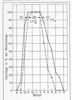
①—Kurve der meteorologisch errechneten Heiztage ( $HT_{12} \leq 12$ °C  $T_m$ )
