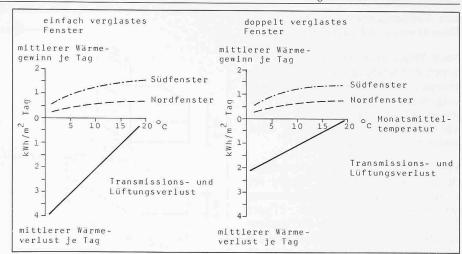
Wärmeverlust und Wärmegewinn je m² Fensterfläche bei einem Glasanteil von 65 % 2
