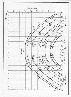
Für die Untersuchung gewählte astronomische Daten, numerierte Fixpunkte für die photographische Besonnungsbestimmung (zu nebenstehendem Bild)
