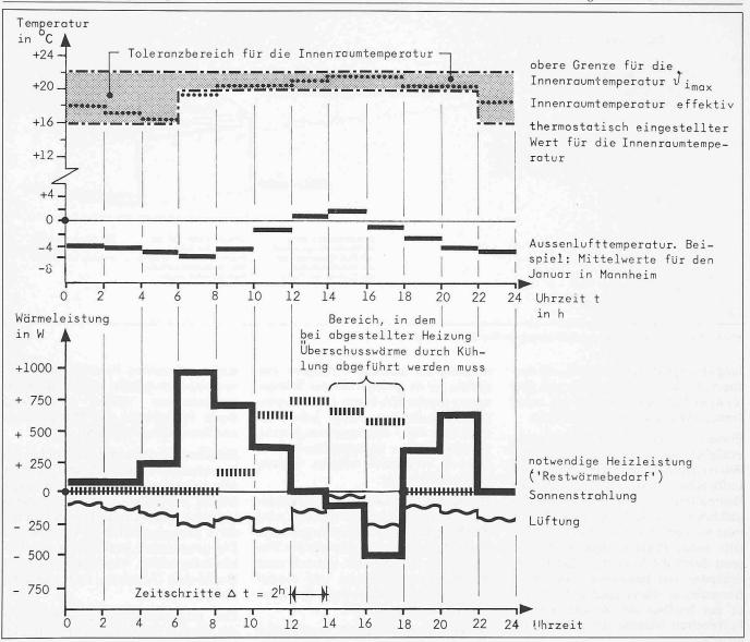
Bild 7. 🛮 Zeitverlauf der Wärmeleistungen, die im Innenraum infolge äusserer und innerer Belastungen auftreten. Für bestimmte Zeitabschnitte 🛆 t werden die Wärmeleistungen als konstant angenommen
