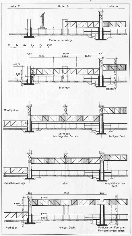
Montage und Anheben der Dachkonstruktion aus Stahl
