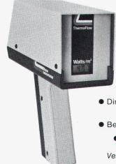
Neuartige, berührungslose Messung von Kältebrücken, Isolationsdefekten, ungenügenden Abdichtungen
