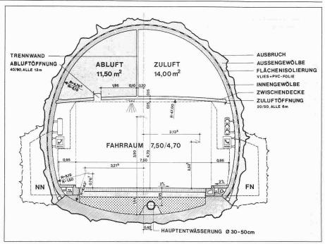
Bild 12. Regelauerschnitt der fertiggestellten südlichen Röhre. Die zunächst in beiden Richtungen betriebene Tunnelröhre mit 90 bis 103 m² Ausbruchquerschnitt hat 50 m lange Abstellnischen (NN) und Feuerlöschund Notrufnischen (FN)
