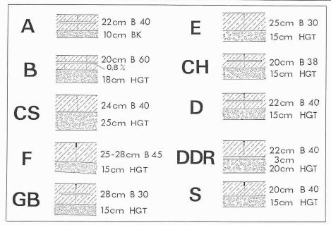
Bild 7. Schichtaufbau von Betonstrassen in verschiedenen Ländern, die der PIARC angehören. BK Bitumenkies, HGT hydraulisch gebundene Tragschicht
