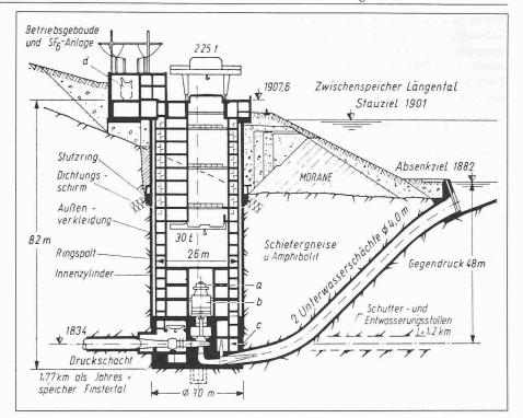
Bild 9. Als Schachtkraftwerk ausgeführtes Pumpspeicherwerk Küthai mit zwei Maschinensätzen (247 MW Motor- oder Pumpleistung und 286 MW Generatorleistung) für die Kraftwerkgruppe Sellrain-Silz. Längsschnitt
