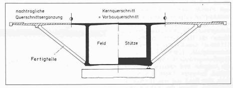
Bild 3. Die 4000 m langen Brückenbaulose Rauchenkatsch und Kremsbrücke der Tauernautobahn mit Brückenquerschnitt zur Aufnahme der beiden Richtungsfahrbahnen: Ortbetonhauptträger mit nachträglich angesetzten Kragteilen
