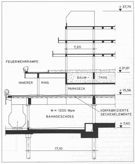
Überbauung des Wiener Franz-Josef-Bahnhofs im Bereich des Frachtenbahnhofes; Wirtschaftsuniversität (Querschnitt). Im Gleisbereich wurden Stahlbetonfertigteile mit grossen Gewichten nachts mit dem Schienenkran eingebaut
