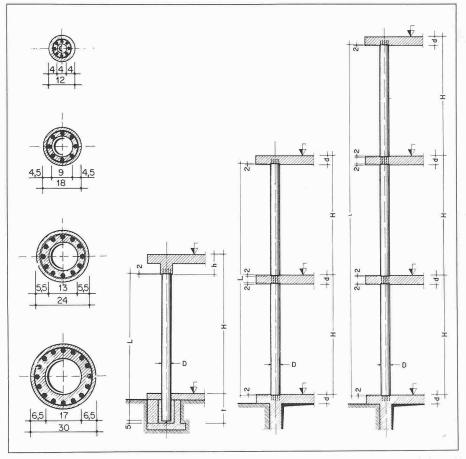
Hochbaustützen (Tragfähigkeit 30 bis 200 Tonnen)
