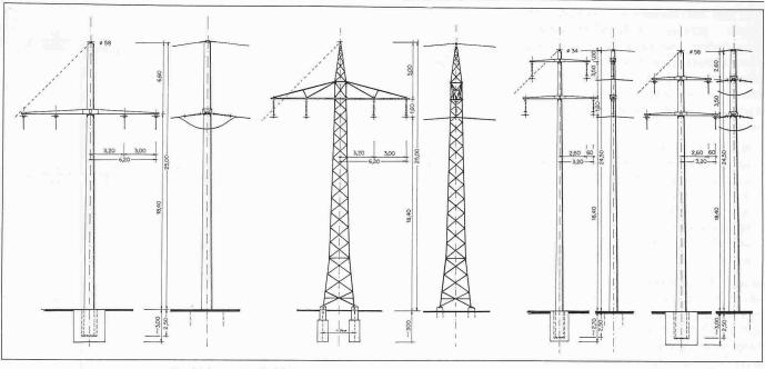
Vergleich zwischen Stahlgittermast und Schleuderbetonmast (2×110-kV-Bahnspeiseleitung)
