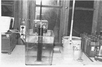
Bild 6. Bestimmung der Dichte des Zusatzmittels mittels Aräometer
