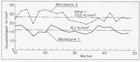
Bild 11. Resultate der Routine 28tägigen Druckfestigkeiten in einem Mörtelwerk während eines Jahres (zwei Langzeit-Mörtelsorten)
