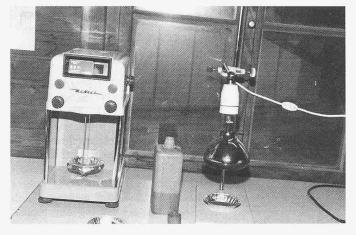
Bild 8. Bestimmung des Feststoffgehaltes mit Verwendung einer Infrarotlampe
