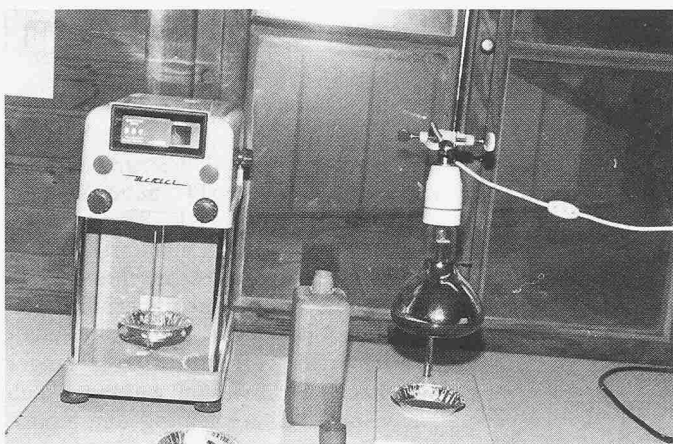
Bild 8. Bestimmung des Feststoffgehaltes mit Verwendung einer Infrarotlampe
