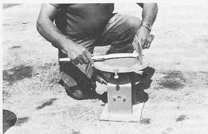
Bild 4. Messung des Ausbreitmasses nach DIN 18555
