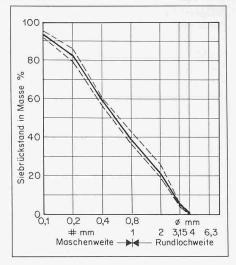
Bild 2. Aus Rund- und fillerreichem Brechsand zusammengesetzter Mauermörtelsand von einem Mörtelwerk. Durchschnitt und Streubereich aus sechs Aussiebungen (Jahresstatistik)
