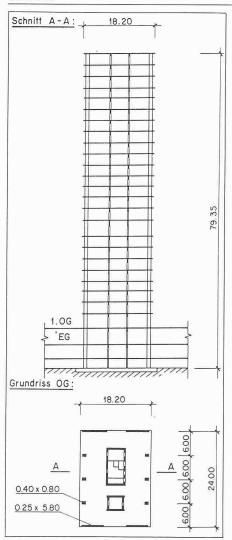
Bild 2. Bauwerk II: Hochhaus mit Kern und Fassadenscheiben
