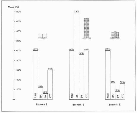
Bild 9. Vergleich der maximalen Momente
