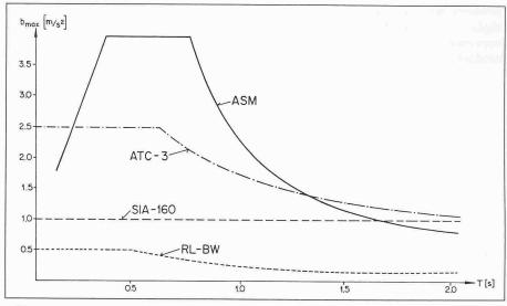
Bild 5. Maximale Beschleunigung im Dachgeschoss eines reinen Rahmentragwerks (wie Bauwerk I) in Funktion der Grundschwingzeit nach SIA-160, RL-BW, ATC-3 und ASM
