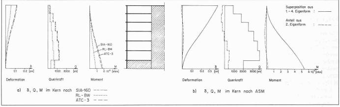
Bild 8. Bauwerk III: Deformationen und Schnittkräfte
