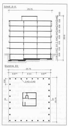
Bild 3. Bauwerk III: Bürogebäude mit Kern und
