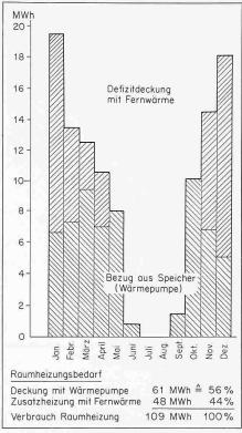
Bild 1. Deckung des Raumheizungsbedarfs ab Speicher bzw. mit Fernwärme
