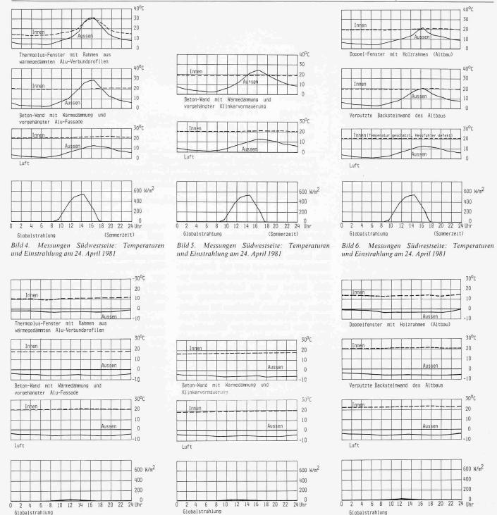
Bild 7. Messungen Südwestseite: Temperaturen und Einstrahlung am 17. Jan. 1980
