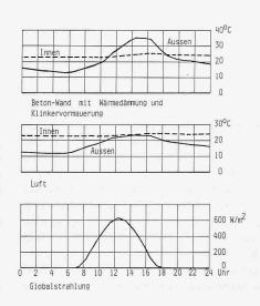
Bild 3. Messungen Südwestseite: Temperaturen und Einstrahlung am 21. Aug. 1980
