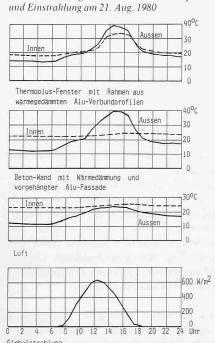
Bild 2. Messungen Südwestseite: Temperaturen und Einstrahlung am 21. Aug. 1980
