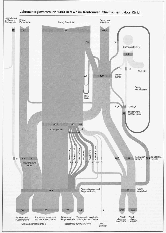
Bild 4. Energieflussschema. Jahresenergieverbrauch 1980 in MWh im Kantonalen Chemischen Laboratorium
