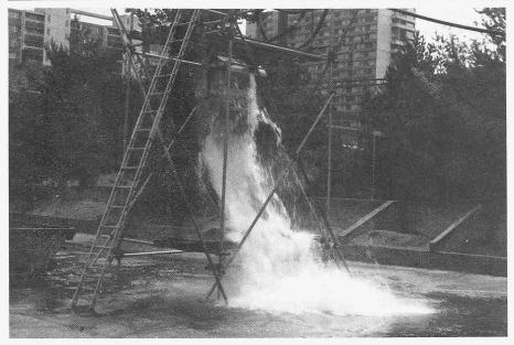
Bild 12. Spülkippe\* beim Entleeren. Fallhöhe: 2,00 m.
