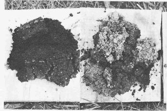
Bild 7. Struktur des entwässerten Schlammes vor (links) und nach der Branntkalkbeimischanlage (rechts)
