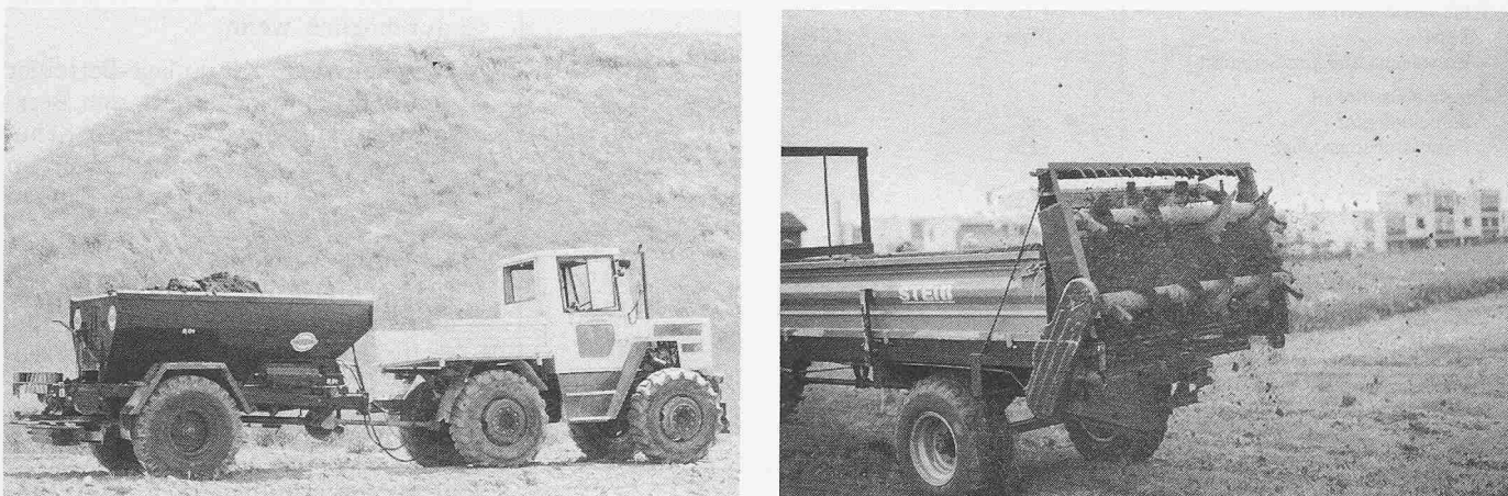
Bild 8. Streuversuche mit zwei verschiedenen Mistzettern
