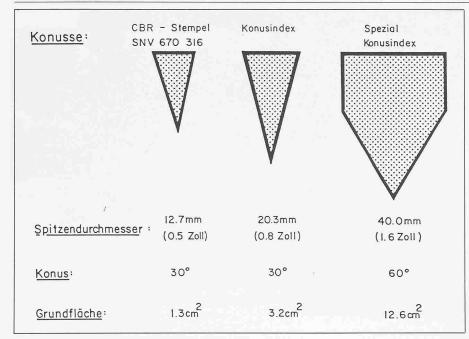
Bild 5. Penetrometer. Technische Daten der verschiedenen Konusse
