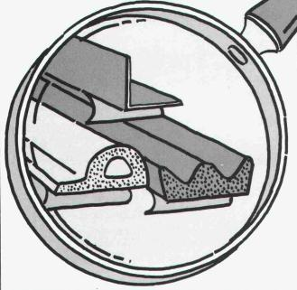
Die selbstklebenden Dichtungsprofile aus Polypropylen und APTK\*Schaumstoff lösen Ihre Dichtungsprobleme an Türen und Fenstern.
