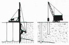
Beton - Schlitzwände für Baugruben- und Ufersicherungen Bohrofähle für Fundationen und Baugrubensicherung Einpresspfähle für Unterfangungen, Trägerbohrungen Filterbrunnen und Grosslochbohrungen, Grundwasserabsenkung.
