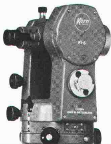
Kern K 1-S. Ingenieurtheodolit mit Skalenablesung
