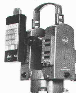
Kern E 1. Elektronischer Theodolit mit Registriergerät
