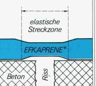
EFKAPRENE®-Brückenabdichtung überbrückt Risse und widersteht dem Tausalzwasser, der Einbauhitze von Gussasphalt und der Schubbeanspruchung
