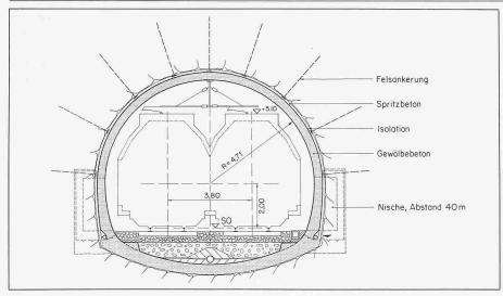
Bild 2. Tunnelprofil im Effinger Mergel
