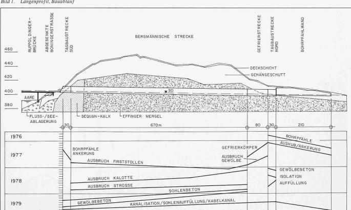
Bild 1. Längenprofil, Bauablauf
