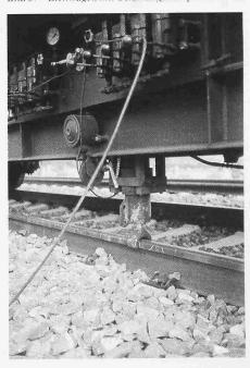
steht aus Einblockbetonschwellen B 70 und Schienen mit Profil VI (UIC 60). Die Schwelle weist eine Höhe von 214 mm, eine Breite von 280 mm und eine Länge von 2600 mm auf. Sie wurde mit normalem Abstand von 600 mm verlegt. Das Trägheitsmoment der Schiene beträgt 3,055 · 10<sup>7</sup> mm<sup>4</sup>.
