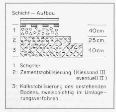
Bild 6. Ausführung der Stabilisierung (schematisch)
