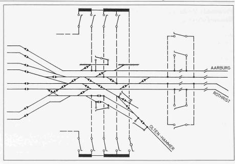
Bild 3. Elektrische Unterteilung (Sektionierung) der Fahrleitung im Südkopf des PB Olten
