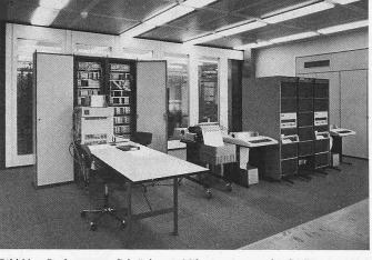
Bild 11. Rechnerraum, Schränke mit Mikroprozessoren für die Zugnummernmeldung und Zuglenkung ZN 80 während der Testphase (links), Rechner PDP11 mit Service-Terminal für die codierte Stellwerkbedienung (rechts)
