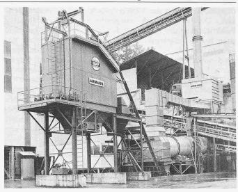
Trommelmischanlage. Leistung: 200 t/h. Ausrüstung für die Beigabe bis 50% Asphalt-Recyclingmaterial. Trockenfilter-Entstaubungsanlage. Mischgutsilo (100 t)
