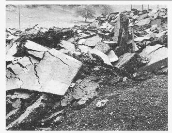
Bild 1. Deponie von Belagsaufbruch für das Recycling
