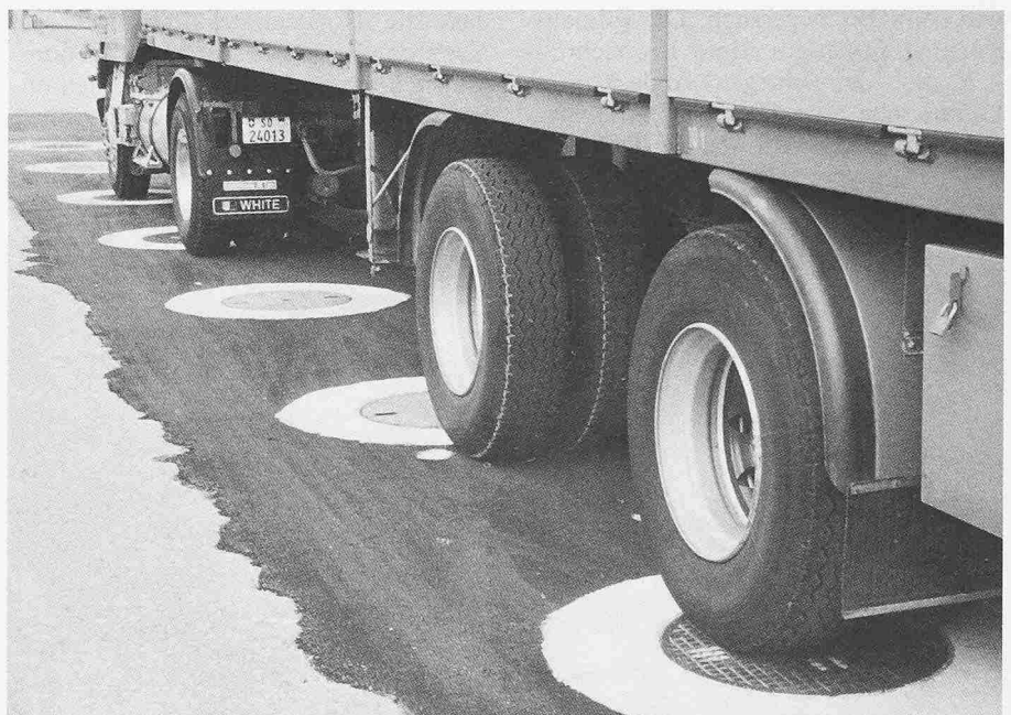
Bild 3. Anordnung der Belastungsversuche mit einem Sattelschlepper
