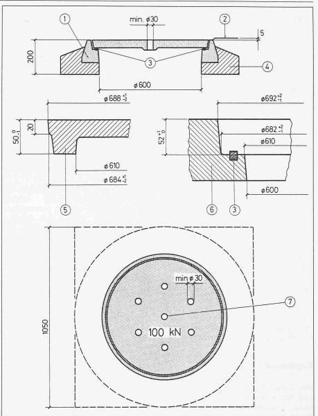
Abmessungen und Toleranzen für Schachtabdeckungen gemäss VSS-Norm «Strassenentwässerung». (1) Gussrahmen (2) OK-Belag (3) Kunststoffeinlage (4) Betonuntersatz (5) Deckeldetail (6) Rahmendetail (7) Pickelloch
