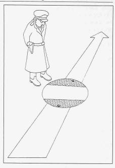
Bild 5. Schachtabdeckung ohne Drehsicherung! (Bild aus dem «Nebelspalter»)
