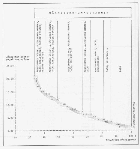
Bild 9. Beispiele für die Optimierung von Wärmeschutzmassnahmen. Verbesserungsmassnahmen in einzelnen Stufen
