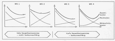
Bild 2. Evaluation von Wärmeversorgungssystemen (WVS) durch Vergleich der Gesamtkostenminima bezüglich einer baulichen Situation
