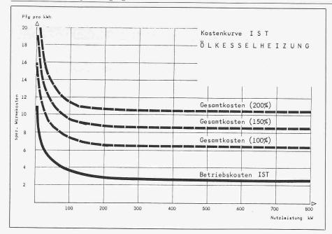
Bild 13. Spezifische Heizkosten in Abhängigkeit von der Anlagenleistung
