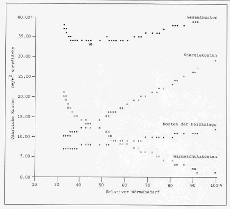
Bild 19. Optimierung von Wärmeschutz und Wärmezuführung, Computergraphik
