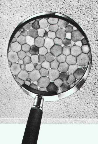
1 m³ Polystyrol-Hartschaum besteht aus rund 3-6 Milliarden mikroskopisch kleinen luftgefüllten Zellen. Darauf beruhen die hervorragende Wärme-Dämmfähigkeit und die hohe Druckfestigkeit von Polystyrol-Hartschaum. Das leichte Eigengewicht und die vielen anderen vorzüglichen Eigenschaften machen Polystyrol-Hartschaum zum idealen Isoliermaterial
