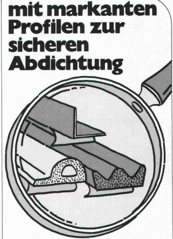
Die selbstklebenden Dichtungsprofile aus Polypropylen und APTK\*Schaumstoff lösen Ihre Dichtungsprobleme an Türen und Fenstern.
