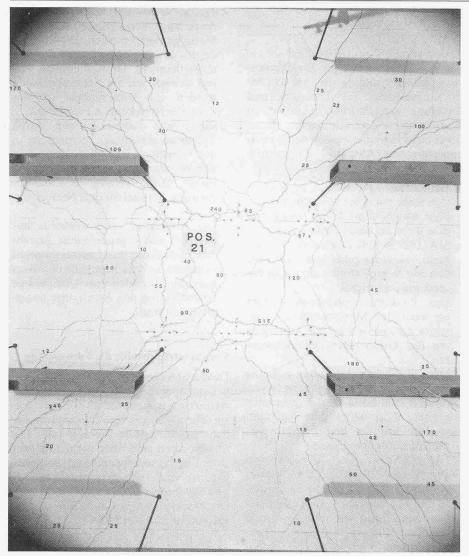
Bild 4. Rissbild aus EMPA-Versuch [3]. Last: 353,6 kN. Die Lage der Trigon-Armierung ist gestrichelt eingezeichnet. Sehr schön sichtbar ist, wie regelmässig alle 20 cm ein Riss quer zur Hauptarmierung verläuft
