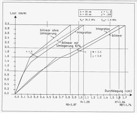
Bild 10. Durchbiegungen eines 12 m langen, beidseitig eingespannten Balkens
