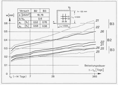
Bild 2. Entwicklung der Rissbreiten
