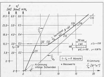
Bild 8. Berechnete und gemessene Durchbiegungen. Belastungsdauer 6 Monate
