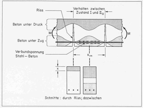
Bild 4. Biegebeanspruchter Stahlbetonträger
