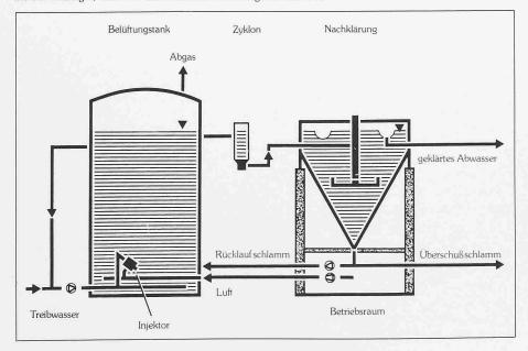
In den 20er Jahren baute man in Deutschland die ersten grösseren biologischen Abwasserreinigungsanlagen, um den natürlichen Selbstreinigungseffekt der Flüsse auf konzentriertem Raum nachzuvollziehen. Der Prozess lief - und läuft heute noch vielerorts - in flachen Abwasserbecken ab, in denen mit Rührwerken oder am Boden installierten Belüftern der für die Mikroorganismen erforderliche Luftsauerstoff eingebracht wird, damit diese Organismen ihre Arbeit - den Abbau von Verschmutzungen -
