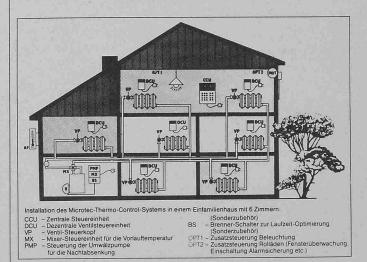
dung. Die verschlüsselte Information wird ganz einfach über das bestehende Stromnetz, von der Steckdose zum Raumtemperaturfühler und auf das Heizkörperventil übertragen.
