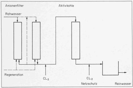
Bild 5. Ionenaustauscher: Schema der Pilotanlage
