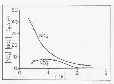
Bild 3. Nitrat (NO3)- und Nitrit (NO2)-Konzentration am Ausgang des im Gleichstrom betriebenen biologischen Kontaktors: Einfluss der Verweilzeit
