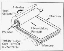
Bild 8. Umgekehrte Osmose: Aufbau eines Mo-
