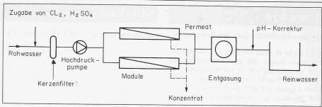
Bild 7. Schema einer Umkehrosmoseanlage
