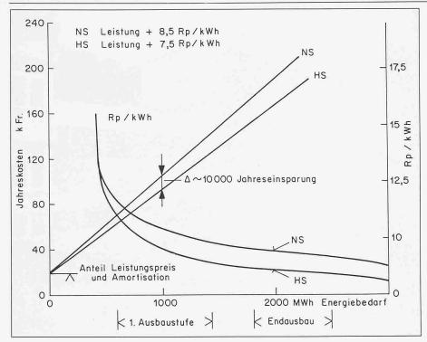
Bild 1. Kostenamortisation der Trafostation
