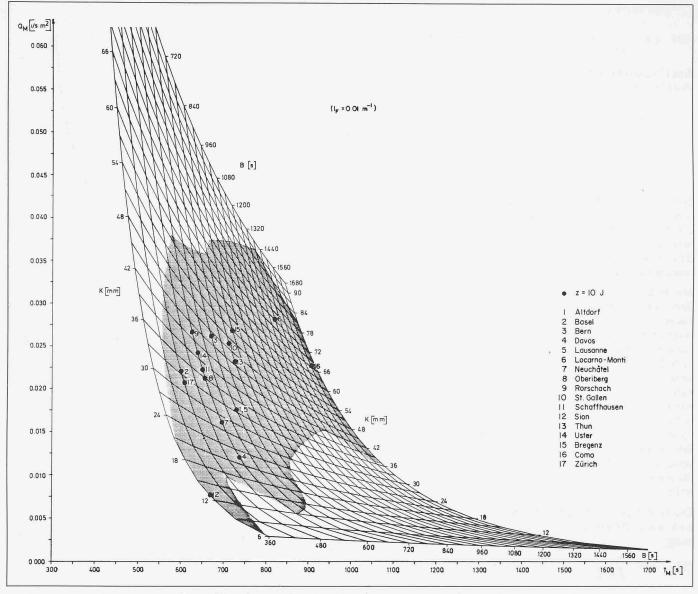
$Bild\ 9.\quad Diagramm\ zur\ Bestimmung\ von\ T_{M,O}\ und\ Q_{M,O}\ f\"ur\ ein\ Dach\ mit\ l_F = 0,01\ m^{-1}\ in\ Funktion\ von\ B\ und\ K(z)\ in\ der\ Formel\ (12)\ (vgl.\ auch\ Tabelle\ 1)$
