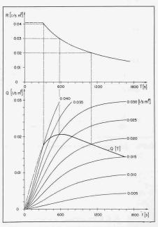
Bild 11. Bestimmung der massgebenden Regendauer T<sub>M</sub> (z<sub>i</sub>) und des massgebenden Abflusses Q<sub>M</sub> (zi) für die Regenintensitätskurve mit der Jährlichkeit zi und einem Dach mit bekanntem lF
