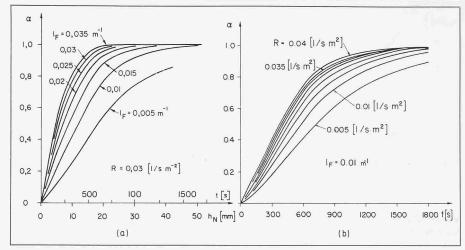
Bild 12a. Abhängigkeit des Abflusskoeffizienten von der spezifischen Überfall-Länge l<sub>F</sub> für einen Regen der Intensität  $R = 0.03 l s^{-1} m^{-2} mit zunehmen$ der Regendauer
