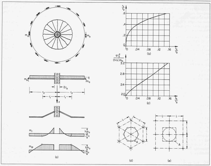
Bild 10. Endliche Stützenabmessungen. (a) Am Innenrand eingespannte Kreisringplatte unter gleichmässig verteilter Flächenlast und Randmoment am freien Aussenrand; (b) Radius des Fliessgelenkkreises; (c) Traglast in Abhängigkeit des Stützenradius; (d) Flachdecke mit regelmässig sechseckigem Stützenraster; (e) Quadratischer Stützenraster
