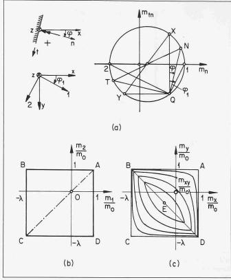
Bild 5. Spannungstransformation und Fliessbedingung. (a) Mohrscher Momentenkreis; (b) Fliessbedingung in der Ebene  $m_1/m_0$ ,  $m_2/m_0$ ; (c) Fliessfläche im Raum  $m_x/m_0$ ,  $m_y/m_0$ ,  $m_{xy}/m_0$
