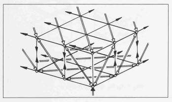
Randebenen entsprechen der Querkraft  $V_t = m_{nt}$ , vgl. (18). Zu ihrer Aufnahme dient eine zur Plattenebene orthogonale Bewehrung am Plattenrand.
