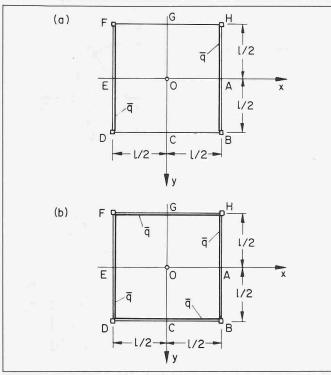
An den Ecken gestützte Quadratplatte unter gleichmässig verteilten Randlasten. (a) Zwei gegenüberliegende Ränder belastet; (b) Alle Ränder bela-
